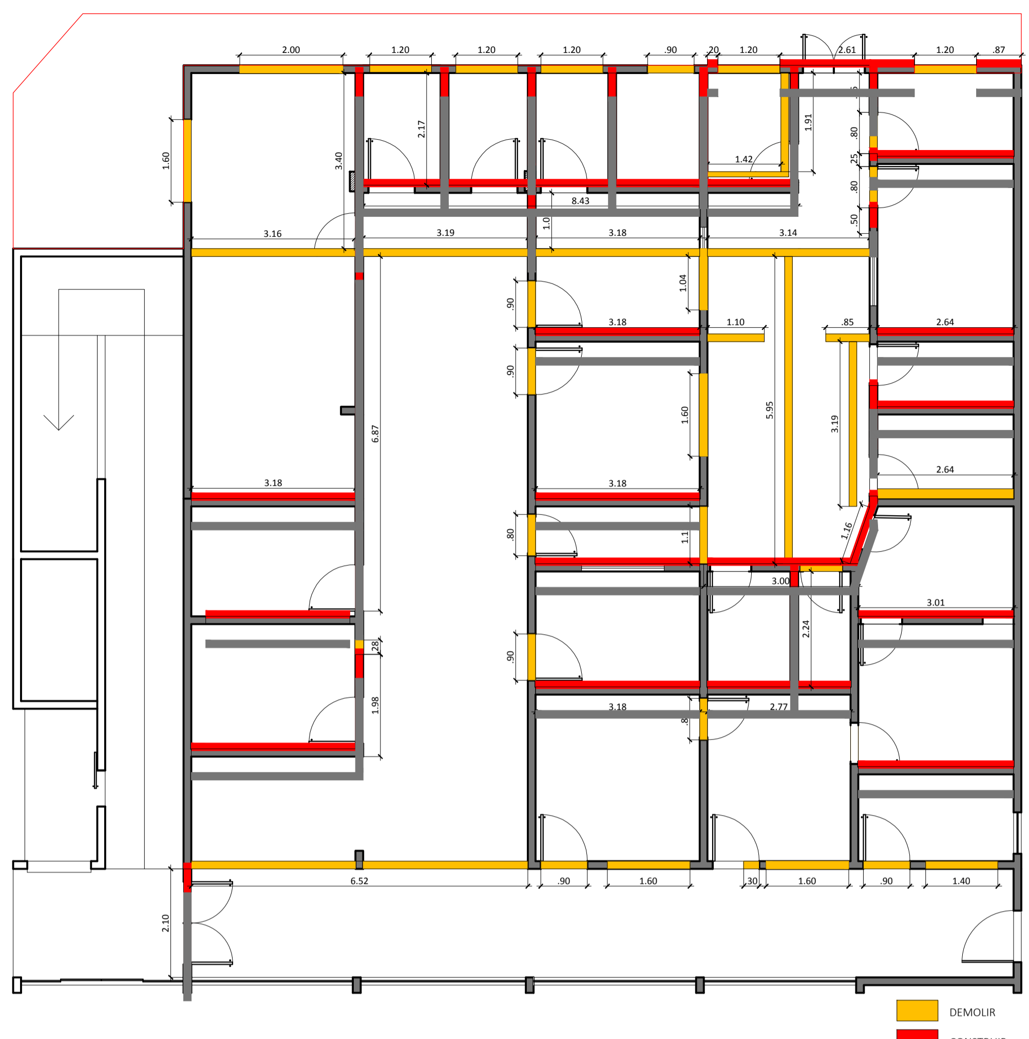
PLANTA BAIXA - DEMOLIÇÃO / CONSTRUÇÃO ESCALA 1:75
